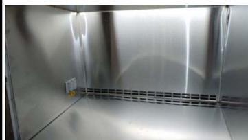
Deflector en acero inoxidable o Lamina con poliepoxico maxima resistencia a productos quimicos y a la abrasi3n (ver tabla de resistencia quimica) Recubrimientos internos del laminado en resina.
