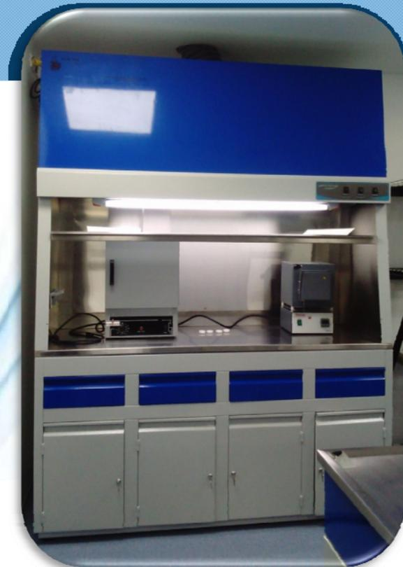
Las cabinas de extracción de gases, son equipos de laboratorio para la protección del usuario ante la exposición a sustancias químicas y agentes peligrosos
